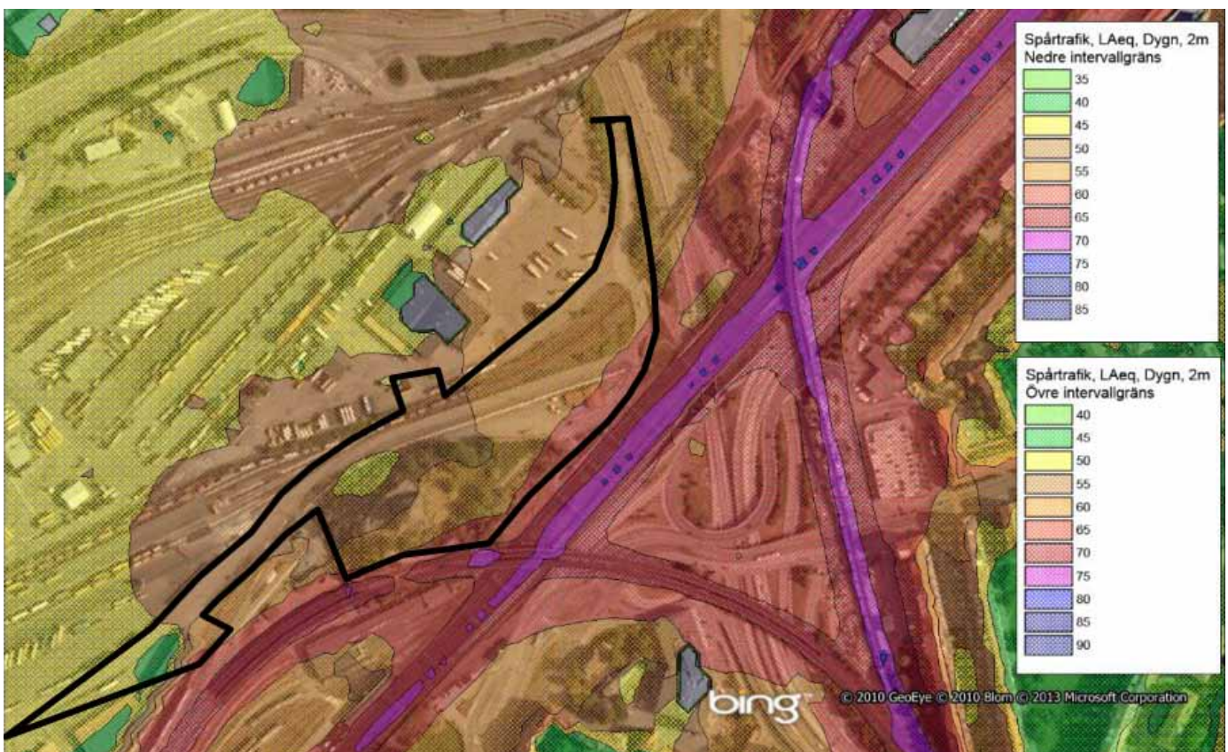
Figur 17.1:4 Ekvivalenta ljudnivåer vid den norra tunnelmynningen, 2 meter över mark från vägrafik (överst) och spårbunden trafik (underst). (Båda utdrag från Sweco, 2013-08-26.)
